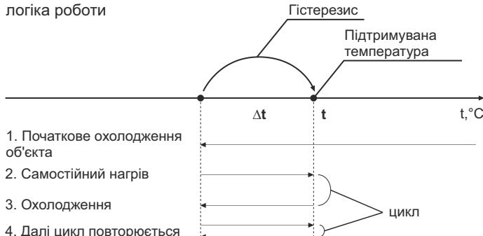
Гістерезис - це різниця між температурою ввімкнення і вимкнення контактів реле терморегулятора (падіння температури).
