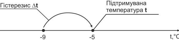
При цьому охолоджувальний елемент, керований терморегулятором, охолоджує морозильну камеру до  $-9^{\circ}\text{C}$  і відключається. Після підвищення в ній температури на  $4^{\circ}\text{C}$ , тобто до  $-5^{\circ}\text{C}$ , терморегулятор знову увімкне охолоджувальний елемент, почнеться охолодження і цикл повториться.
