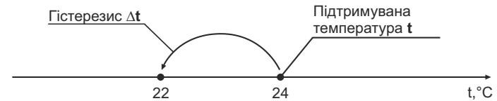
При цьому нагрівач, керований терморегулятором, буде нагрівати приміщення до 24 °C і відключатиметься. Після охолодження приміщення на 2 °C (до 22 °C), терморегулятор знову увімкне нагрівач і цикл повториться.
