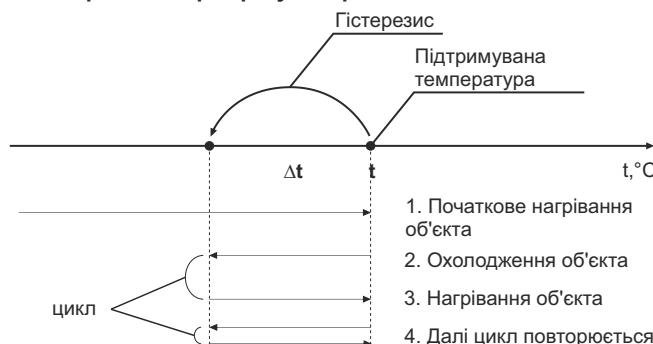
Гістерезис - це різниця між температурою ввімкнення і вимкнення контактів реле терморегулятора (падіння температури).
